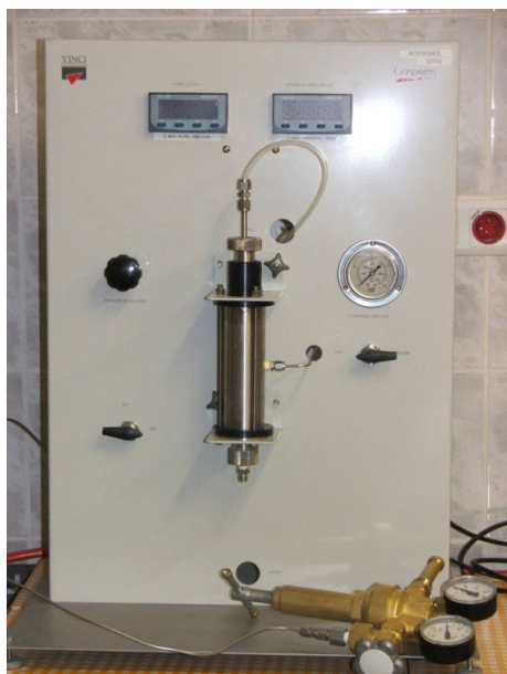
Rys. 5. Aparat do badania przepuszczalności firmy Vinci Technologies (fot. K. Haładyna).
