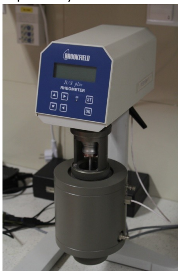
Rys. 10. Lepkościomierz firmy Brookfield (fot. K. Haładyna)
