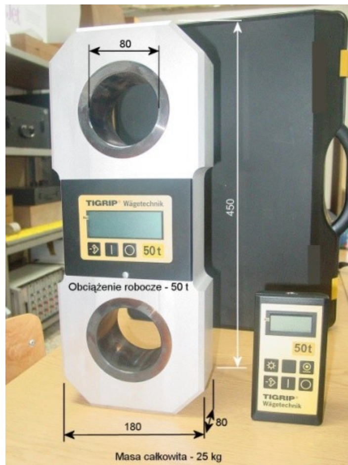
Rys. 1. Dynamometr TIGRIP 50 Wägetechnik, do prób obciążeniowych
