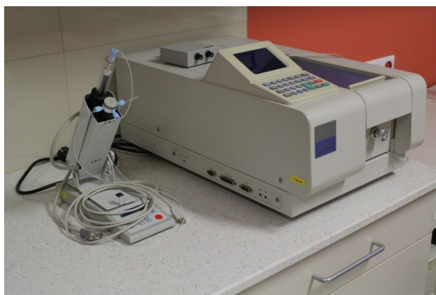
Rys. 8. Spektrofotometr UV-Vis U1900 firmy Hitachi wraz z przystawką do miareczkowania (fot. K. Haładyna)
