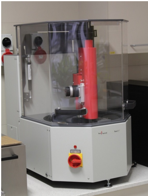
Rys. 3. Aparat do badania czasu wiązania zaczynów cementowych (fot. K. Haładyna).
